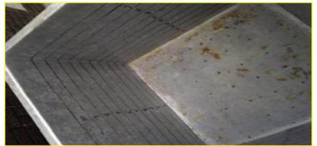
Figure (III.7). les 24 trous à la base de réservoir. M.Y. Fattah, et al. (2016).
