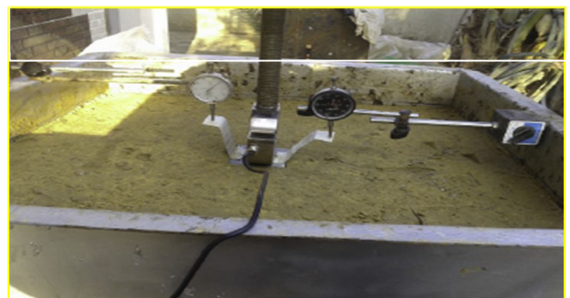
Figure (III.8). La semelle du modèle avec deux ailes. M.Y. Fattah, et al. (2016).
