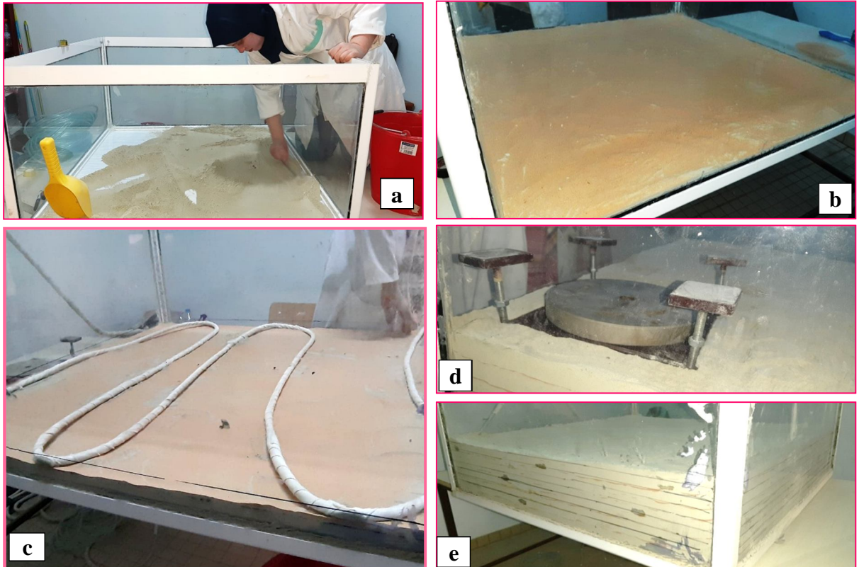
Figure (V.2). Remplissage du Bac.
