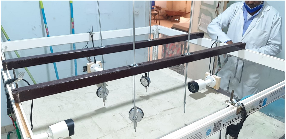
Figure (V.3). Les outils de fixation des caméras et les comparateurs.
