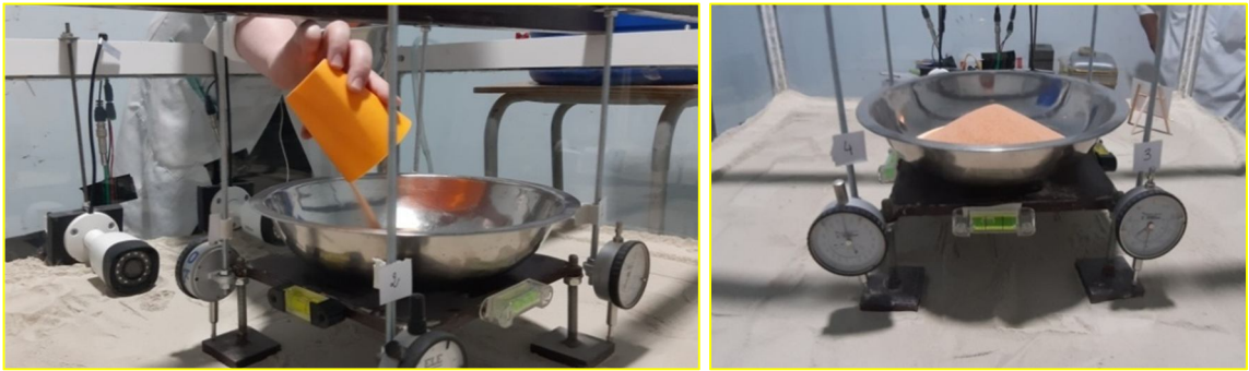
Figure (V.8). L'ajout du poids aux fondations.
