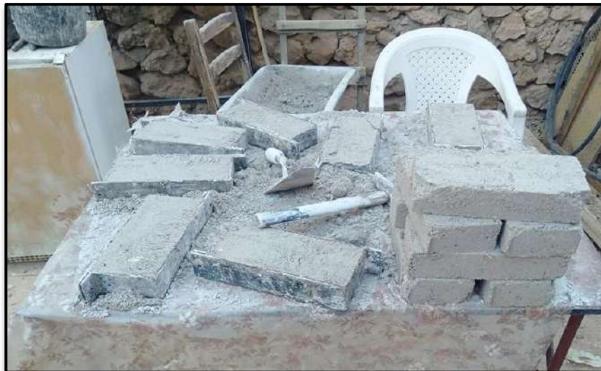
Figure III.4 Démoulage des briques.
