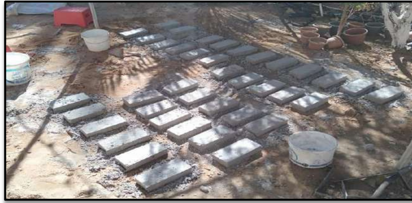
Figure III.5 Les briques au séchage.
