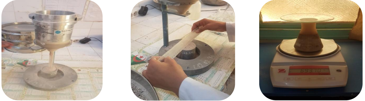
Figure II.2 Essai de la masse volumique apparente et absolue. [19]
