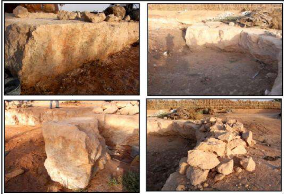
Figure I.9 Gisement de pierre à Bour El Haicha Sol façonné, bloc dégagé, grosses pierres taillées dans le bloc. [8]
