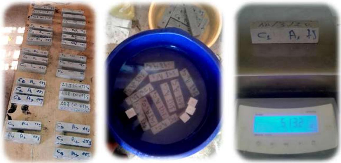
Photo (IV.4) : Essai d'absorption d'eau.
