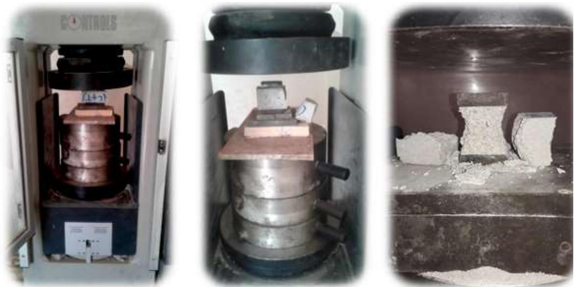
Photo (IV.2) : Essai de résistance à la compression.
