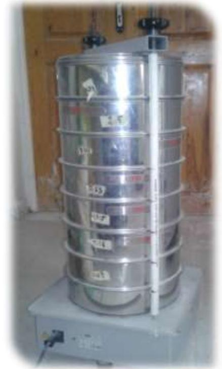
Photo(II.1) : Tamiseuse électrique.
