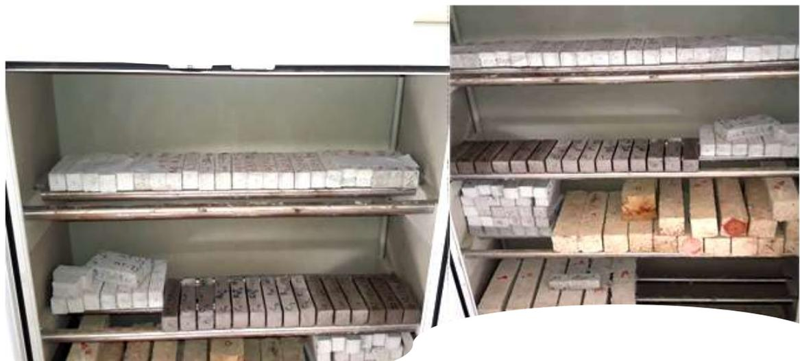
Photo (III .6) : Conservation des éprouvettes dans l'aire libre.
