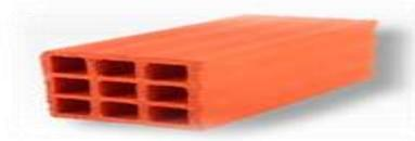
Photo(I.6) : Brique creuse de terre cuite Type C [2].
