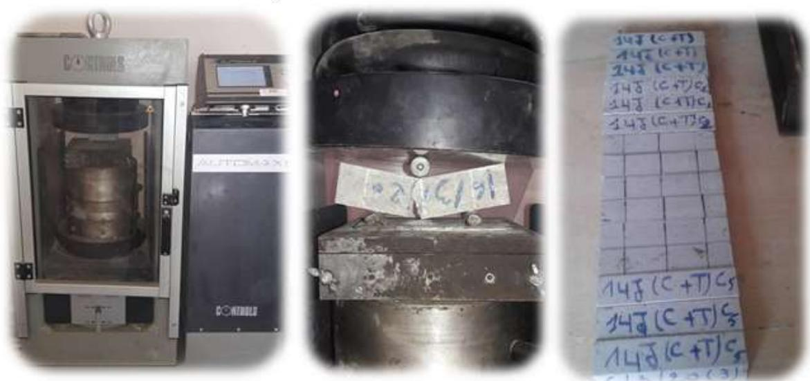
Photo (IV.1) : Essai de résistance à la traction par flexion (3 points).
