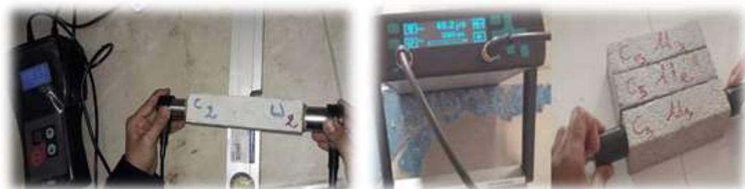
Photo (IV.5) : Essai de Vitesse de propagation d'ondes ultrasoniques.
