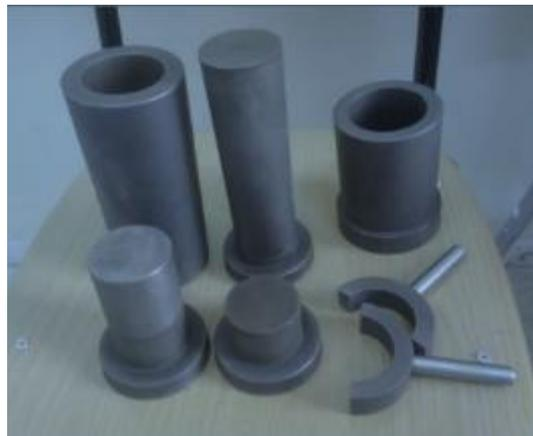
*Figure III-2 Moule et pistons des éprouvettes des essais de compression simple*
