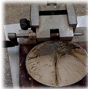
*Figure II-3 Coupelle de Casagrande pendant l'essai*
