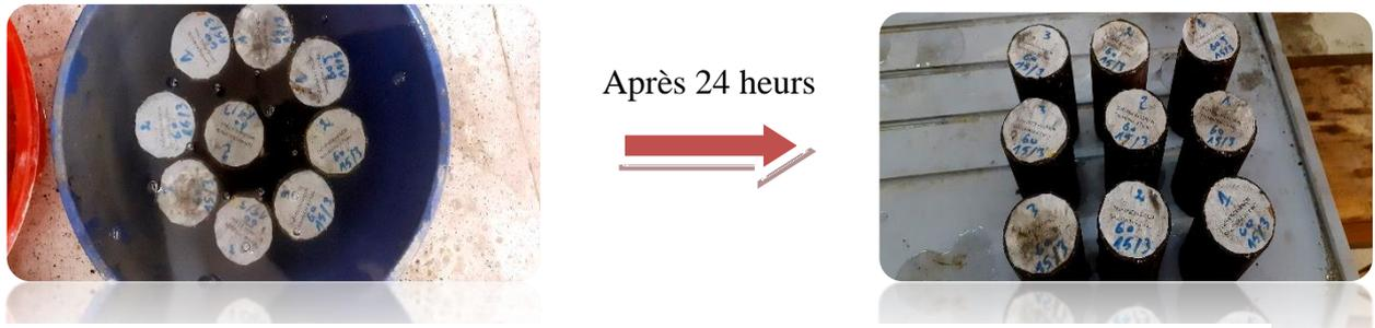
Figure III-19 l'immersion des éprouvettes (tuf + cendre) pour 24 heures dans l'eau nous avons
