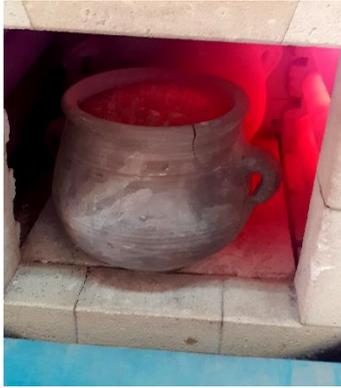
Figure II-15 Incinération des boues dans le four
