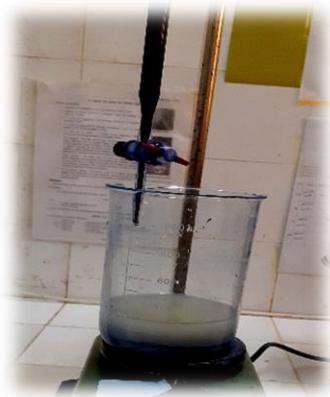
*Figure II-5 Teste de bleu méthylène*
