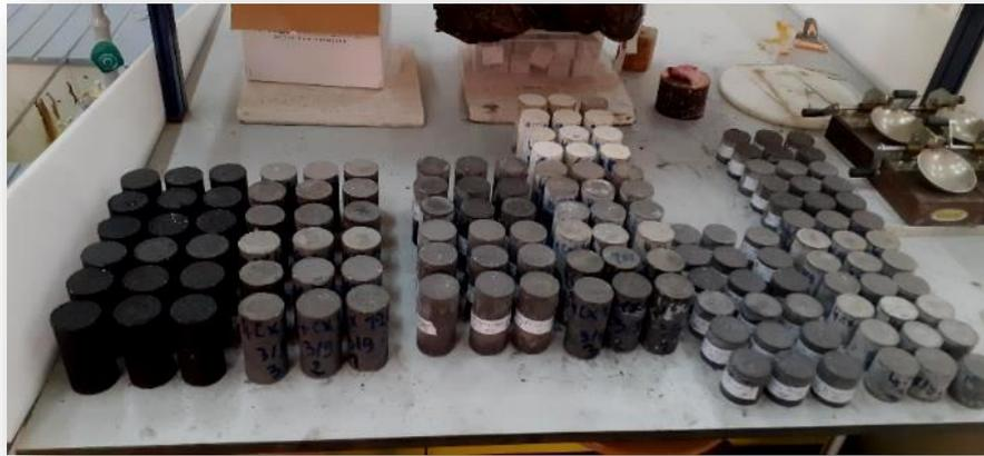
*Figure III-1 Les éprouvettes préparées pour l'essai de compression simple et traction*
