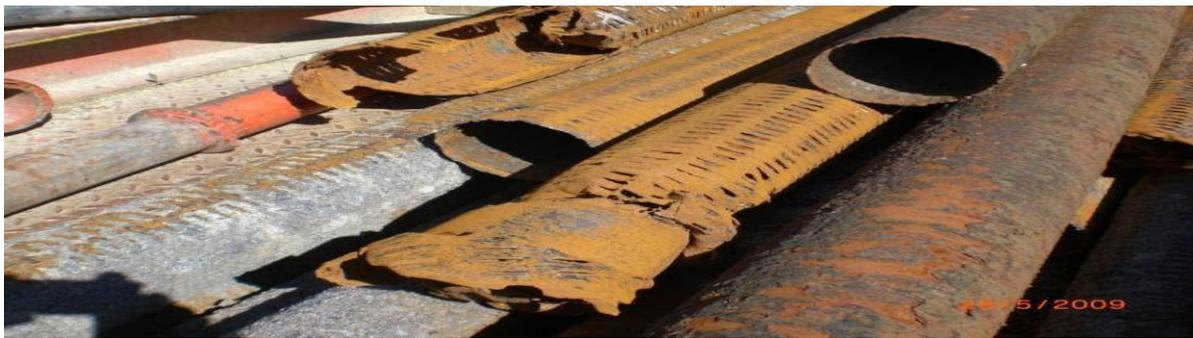
**Figure 17- Image montrant la corrosion généralisée.**
