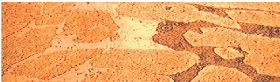
Figure 22- Image montrant la corrosion et dissolution sélective.
