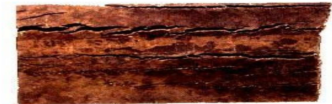
Figure 24- Image montrant la corrosion sous contrainte.
