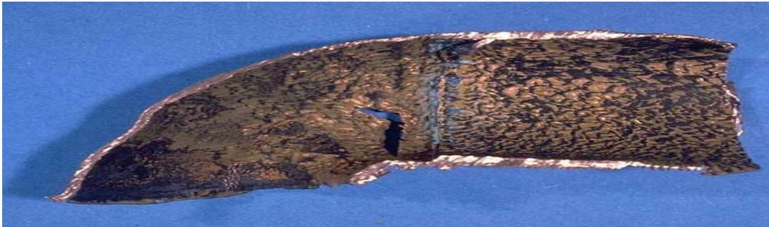
Figure 23- Image montrant la corrosion par frottement.
