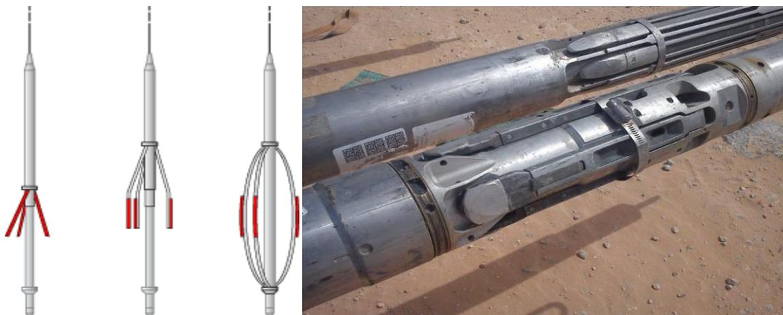
**Figure 30- Images montant la diagraphie de caliper.**
