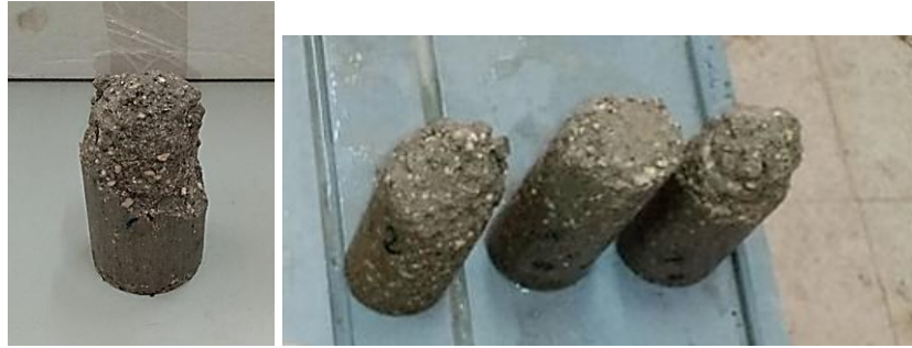
Figure III-17 des éprouvettes de compression à la CRPD après l'immersion de 24h
