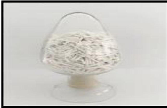
الشكل (IV-13): الزيوليت لصناعة البتروكيميائية [17]
