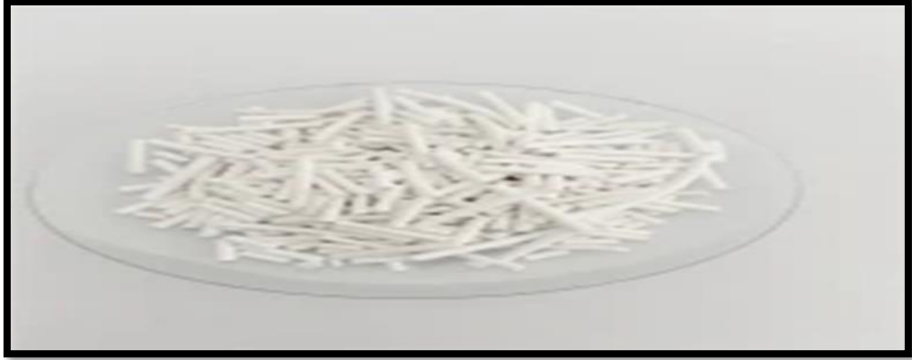
الشكل (III-12): Zsm-5 شركة المحفز الصناعي عالية الانتقائية الزيوليت [17]
