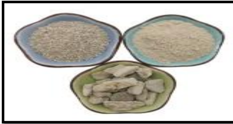
الشكل (14-IV): زيوليت لصنع الاسمنت [17]
