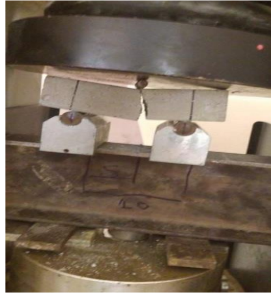
Figure II.37 : Epreuve après rupture
