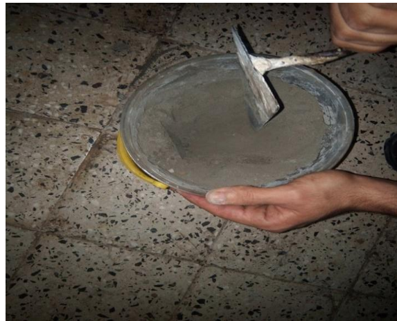
Figure II.24 : Malaxage du mortier
