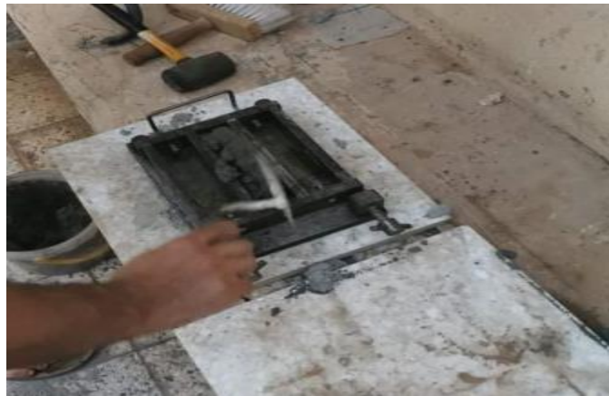
Figure II.26 : Remplissage de l'épreuve prismatic
