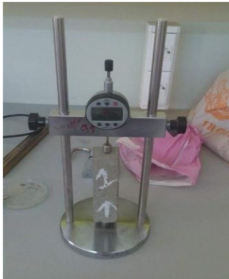
Figure II.38 : Epreuve à l'essai de retrait
