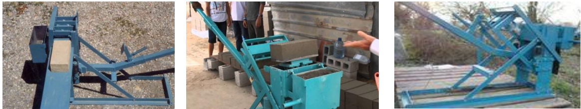
Photo (I.2) : Brique de terre crue compressée à l'aide d'une presse manuelle.
