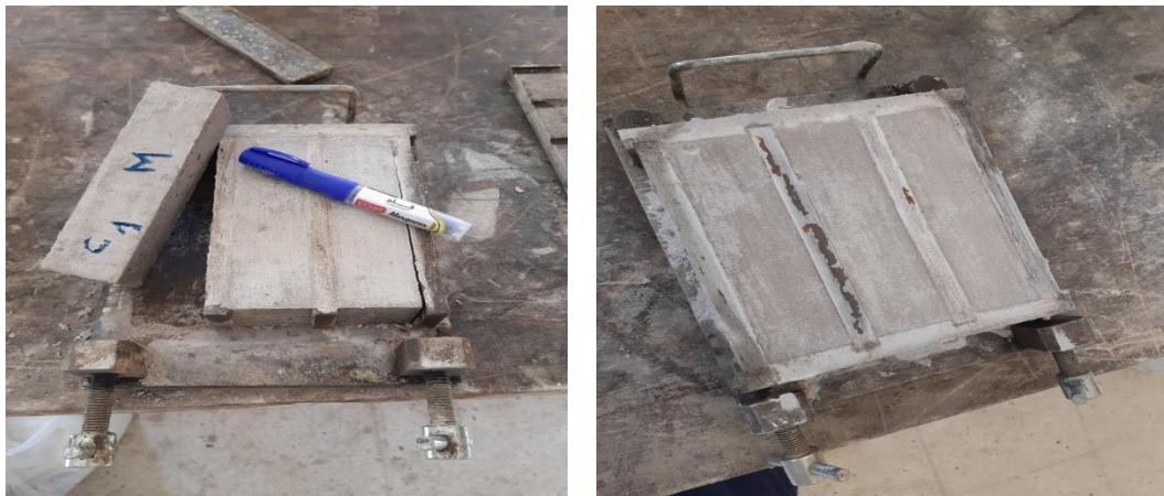
Photo (III.12) : Démoulage des éprouvettes.
