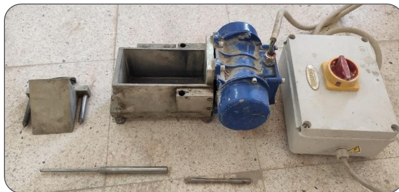
Figure II-6 : machine de l'essai maniabilimètre B.
