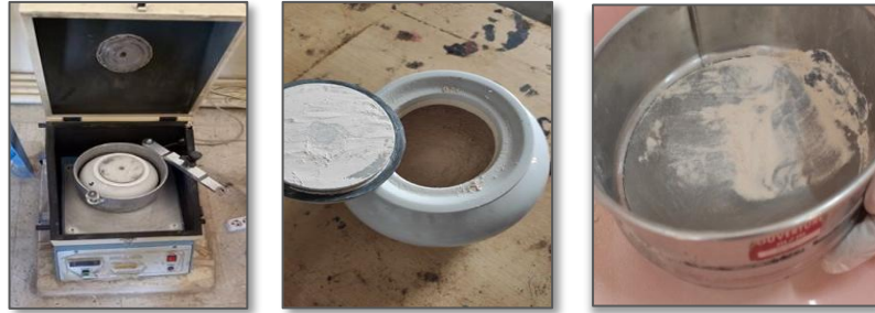
Figure II-8 : les étapes de broyage de sable de dune.
