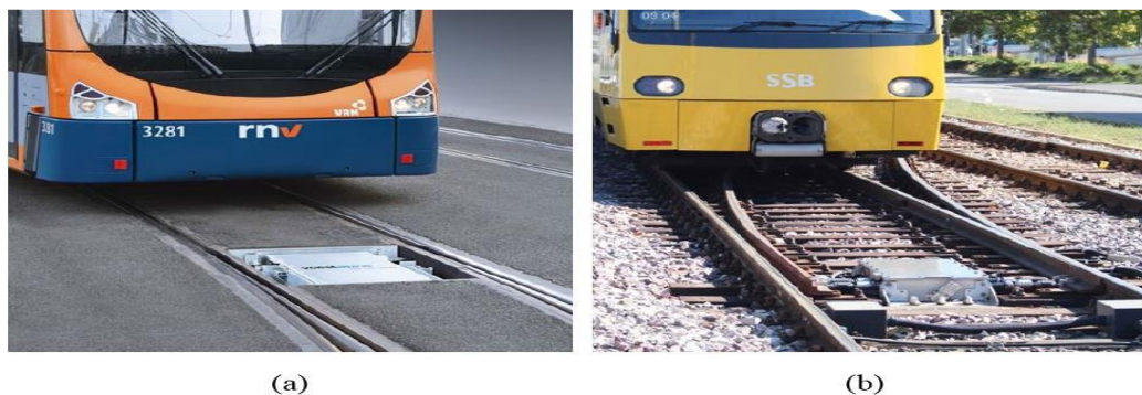
Figure II.24 : Voie encastrée UNISTAR CSV 24 points, écartement de voie de 1000 mm (a) et voie ouverte, écartement de voie de 1435 mm (b) [30].
