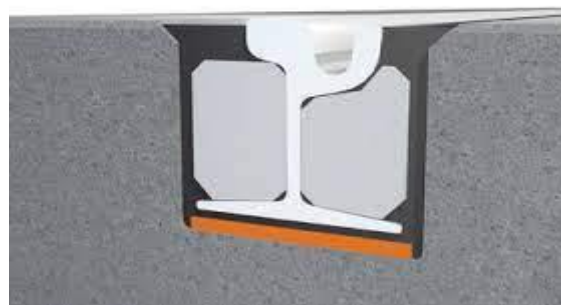
Figure II.4 : Pose avec rail noyé
