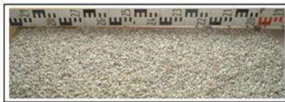
Figure 3.1: Tapis rugueux de rugosité équivalente \varepsilon = 8,73\text{mm} .
