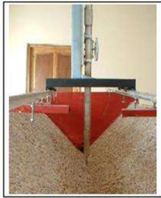
Figure 3.2: Tapis collé soigneusement sur les parois du canal
