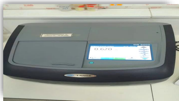
Figure III.8: Spectrophotomètre ultraviolet (DR 6000)
