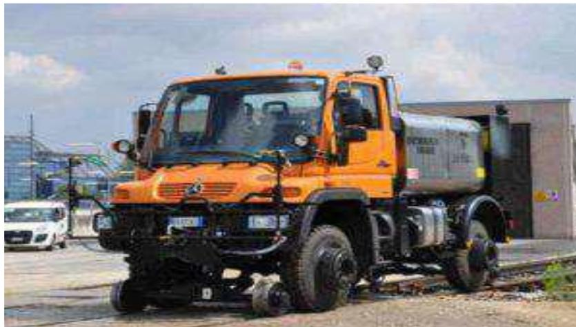
**Figure II.34:** Véhicule railroute Mercedes-Benz UNIMOG U400 Euro
