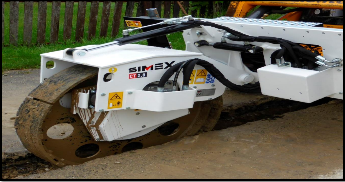
الصورة 9: مدحلة حفر الخندق
