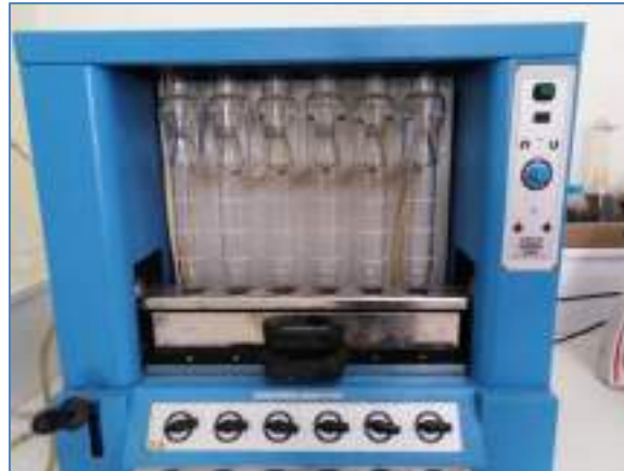
Fig 10. Extracteur de cellulose brute
