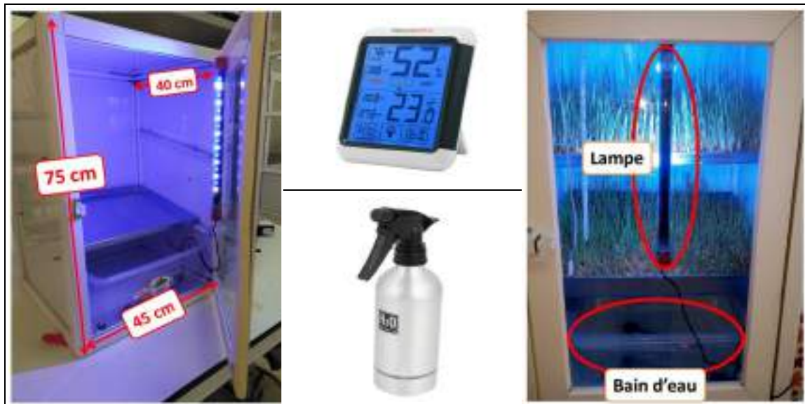
Fig 2. L'unité de germination et ses équipements
