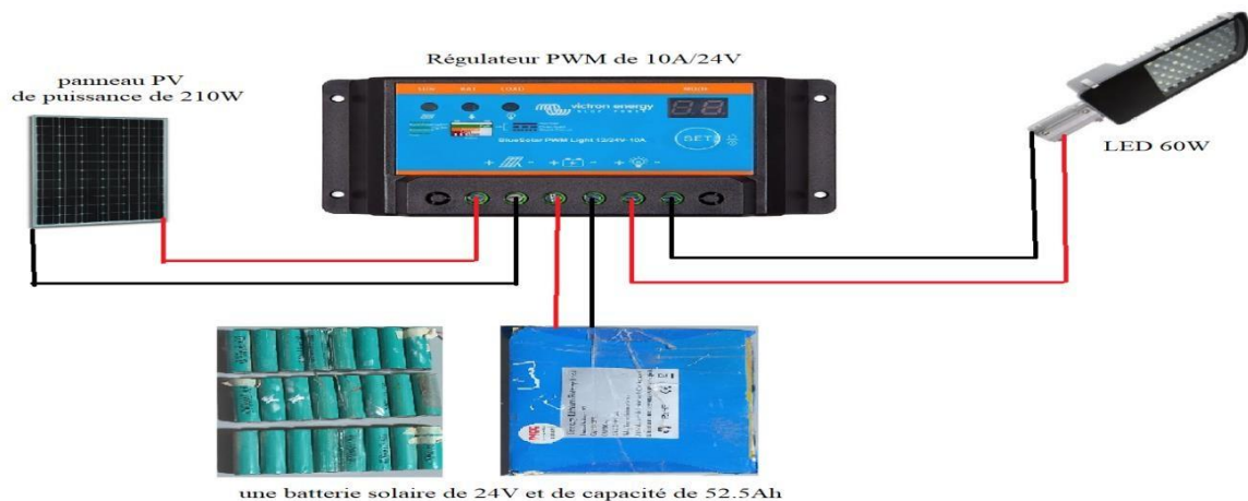
Figure III. 6 Installation photovoltaïque d'un éclairage Autonome.
