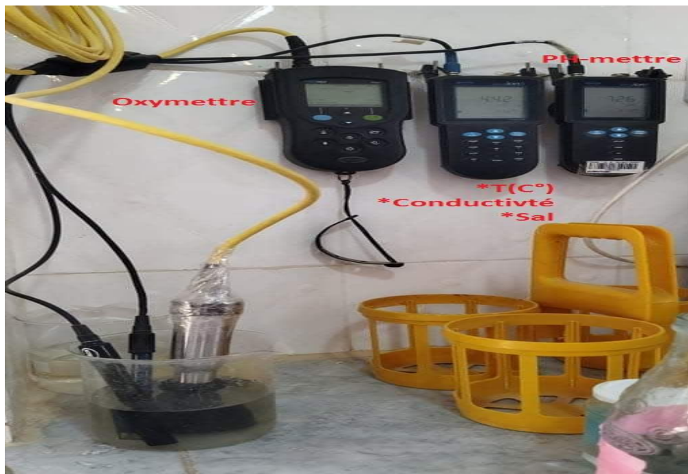
Photo III.6 pH-mètre , Oxymètres ,Conductimètre, salinité (Sal), la température.
