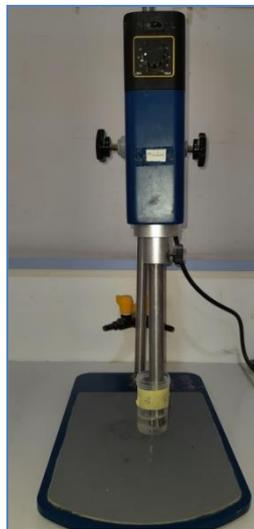
Figure 18. Homogénéisateur
