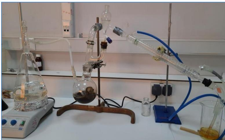
Figure 14. Dispositif d'extraction de la MAT
