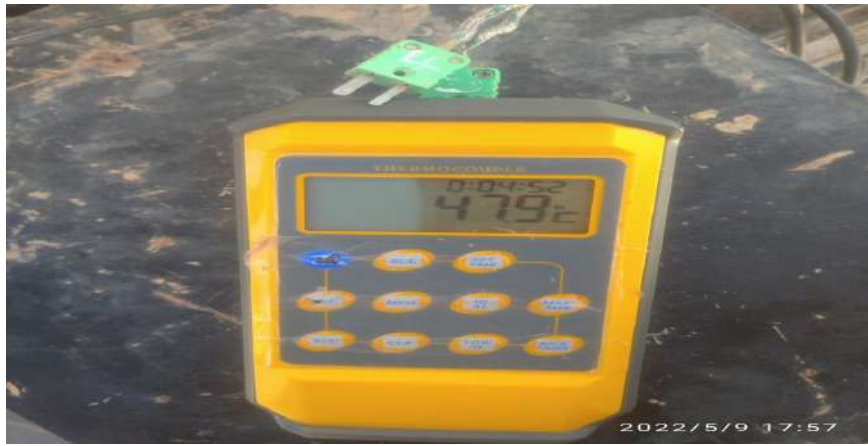
FIGURE III.9 – Thermomètre et Thermocouple
