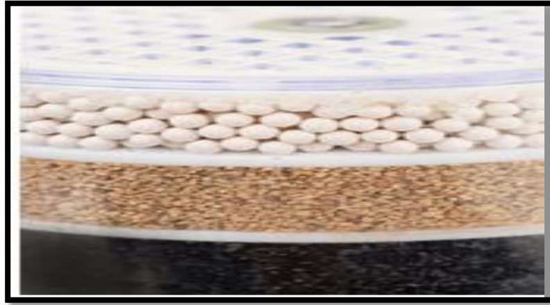
الشكل 8.3. : منظومة أوساط مخلوطة مستخدمة في فلاتر الترشيح
