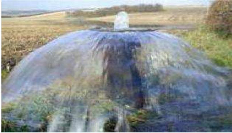
الشكل (2-1) يوضح التهوية باستخدام النافورات
