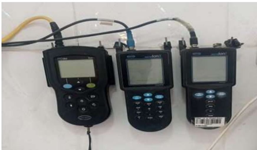
III.4.Photo : Appareil de mesure CE et PH et température (photographie original)
