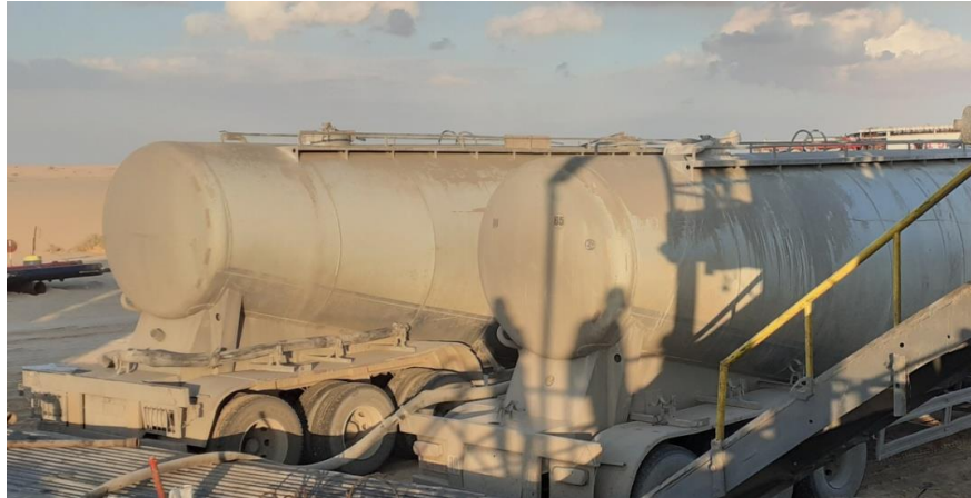
Figure.III.7 : silos de ciment.
