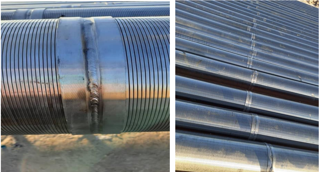
Figure II.33 : crépine INOX Johnson utilisée.
