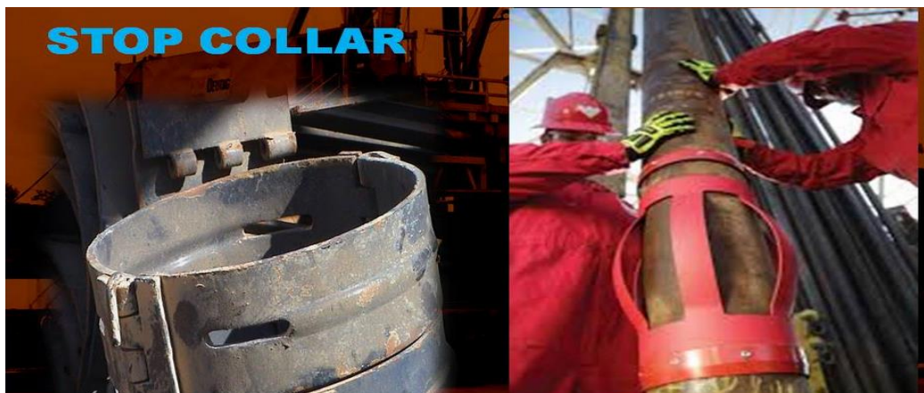
Figure II.30 : Montage d'un centreur avec un stop collar. [07]
