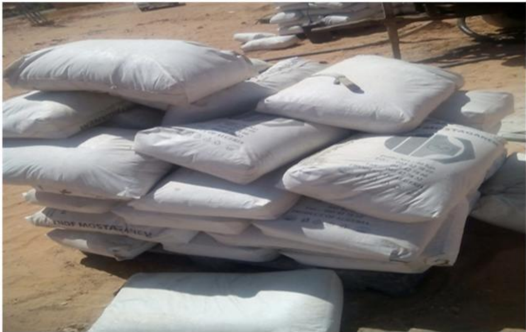
Figure N° 17: Les sacs de bentonite.
