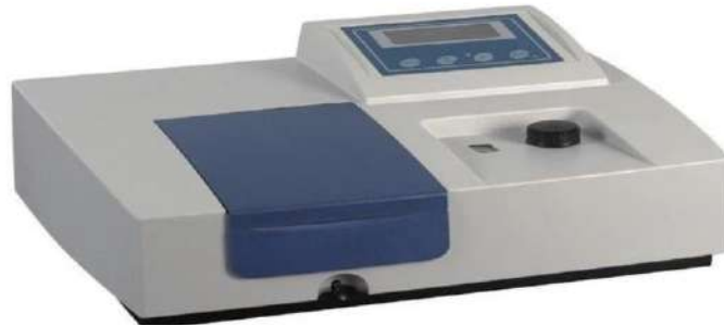
الشكل II-12: جهاز الأشعة المرئية و فوق البنفسجية.
