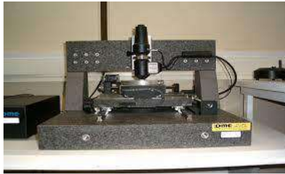
الشكل II-6: مجهر القوة الذرية
