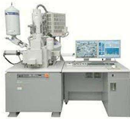
الشكل II 7: المجهر الإلكتروني الماسح
