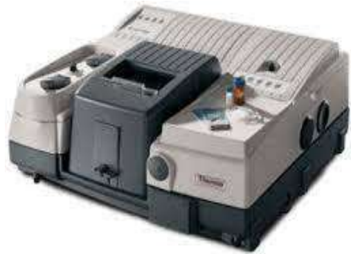
الشكل II-14: جهاز مطياف FTIR.
