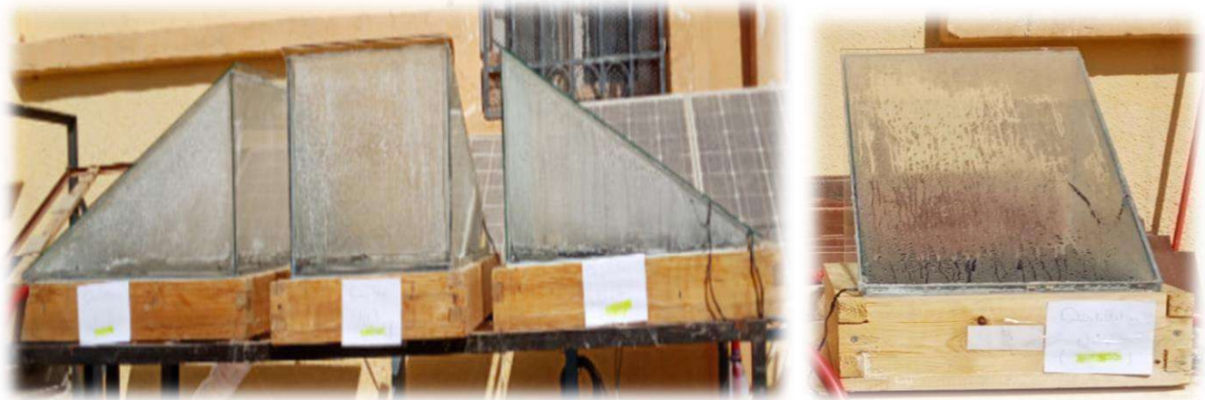
Figure.III.10: Les distillateurs solaires pendant l'expérience (2)
