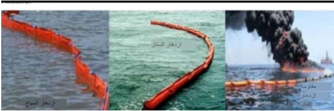
الشكل (11): أنواع حواجز التطويق الطافية.
