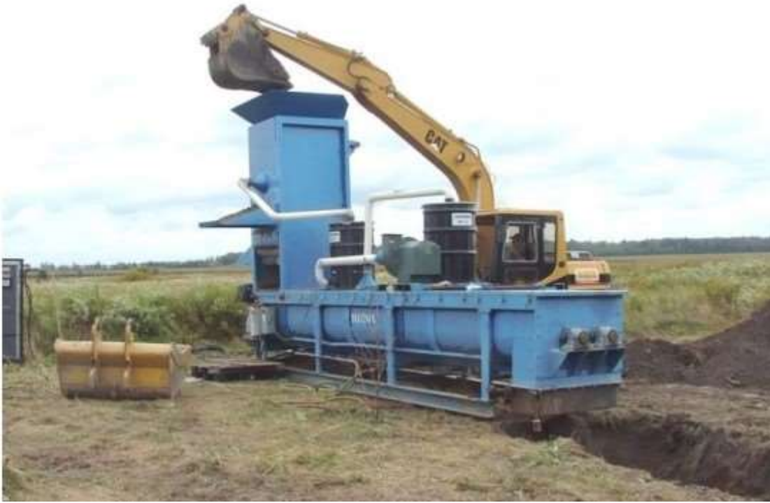
الشكل (3): نظام معالجة الأكسدة الكيميائية خارج الموقع.
