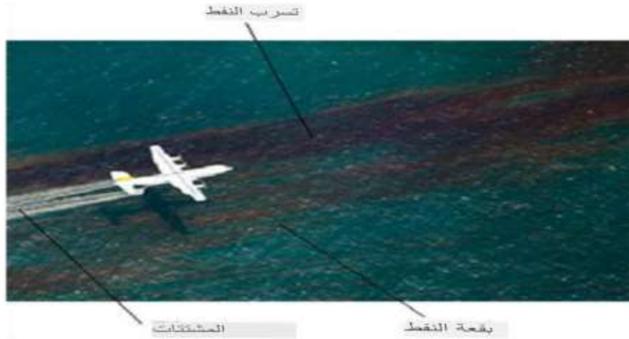
الشكل (12): رش مشتت على بقعة نفط بواسطة طائرة.
