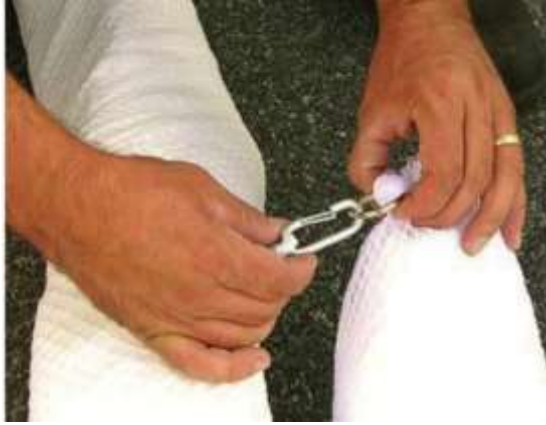
الشكل (15): ربط المشابك المعدنية وأذرع الامتصاص معا للحصول على طول إضافي.
