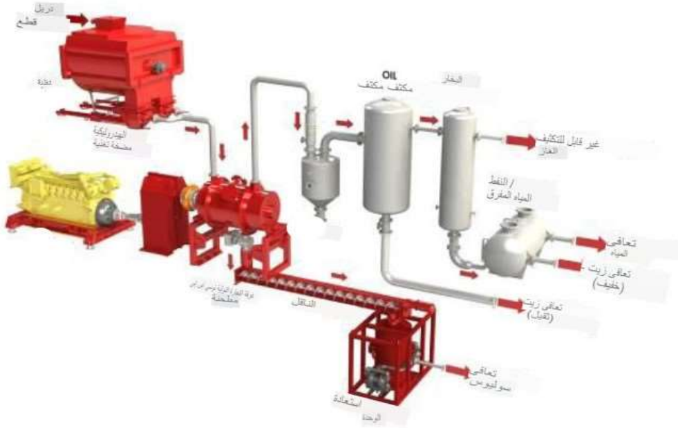
الشكل (9): مخطط تدفق عملية الامتزاز الميكانيكي الحراري TCC.
