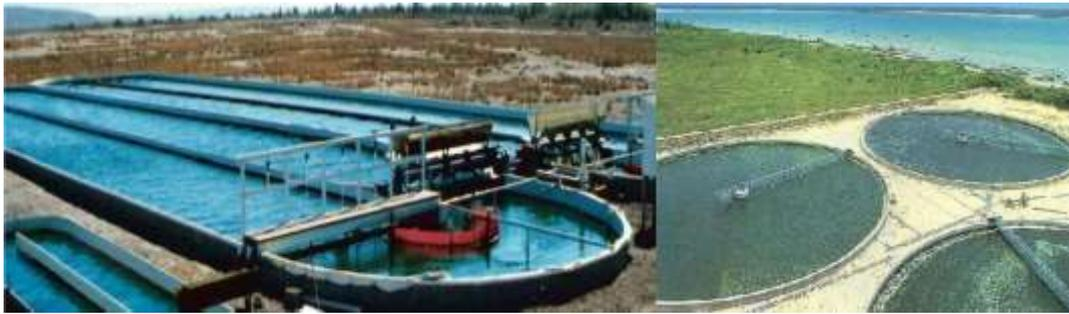
**Figure I.1: A gauche : bassin en boucle fermée, infrastructure de Roswell, Nouveau Mexique (USA) [8]. A droite : bassins circulaires d'environ 500m<sup>2</sup>, production de chlorelle (Chlorella Industries, Japon) [9].**
