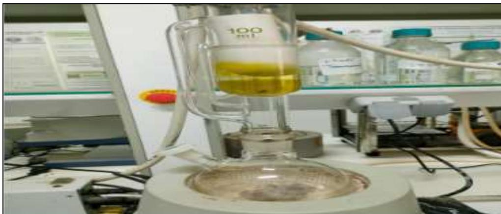
**Figure III.7: appareil d'extraction des lipides Soxhlet**
