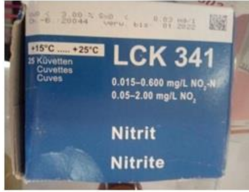
الشكل (15.III): صورة توضح الكاشف المستخدم لقياس النتريت
