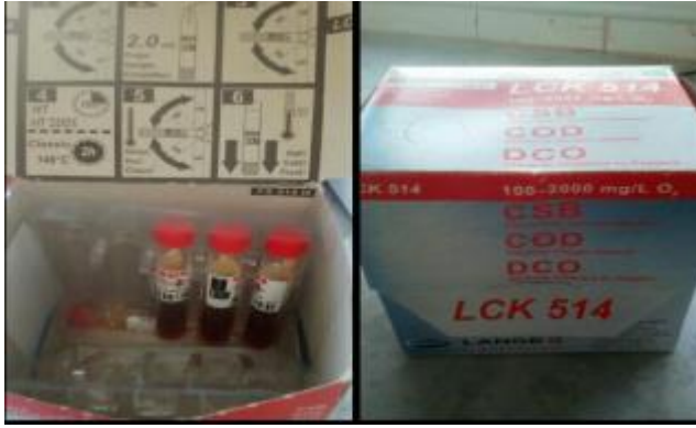
الشكل (12.III): صورة توضح الكاشف المستخدم لقياس DCO.
