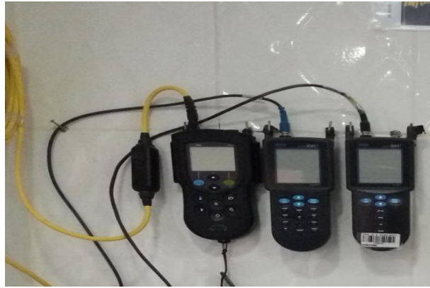
الشكل (17.III): صورة توضح أجهزة قياس عناصر الكيميائية (الناقلية، الأوكسجين، أملاح و PH)
