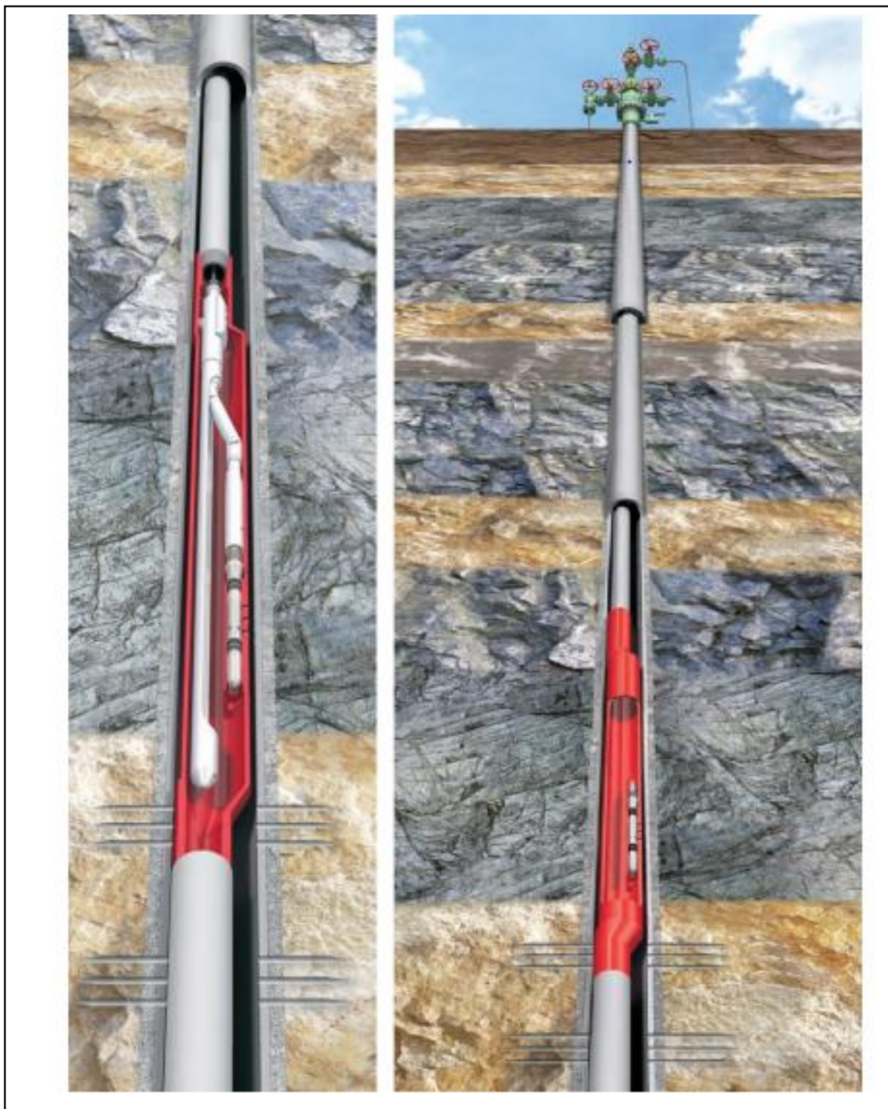
Figure II.2 : Pose d'une vanne GL dans son siège à l'intérieur d'un mandrin par le « kickovertool ».
