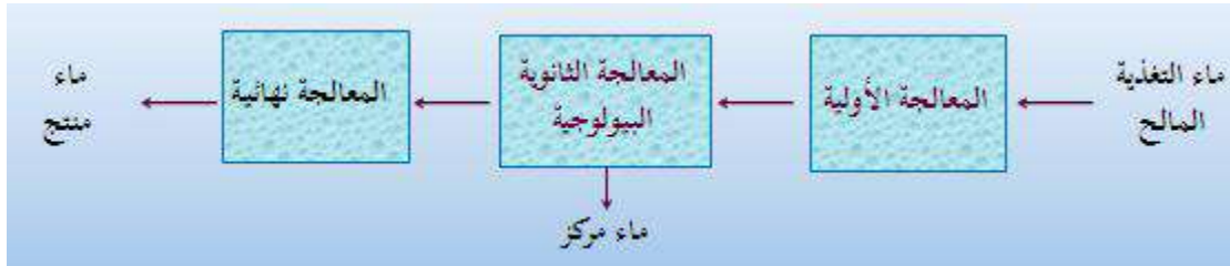
الشكل (II-15): رسم تخطيطي للمكونات الأساسية لمحطة التحلية [23].
