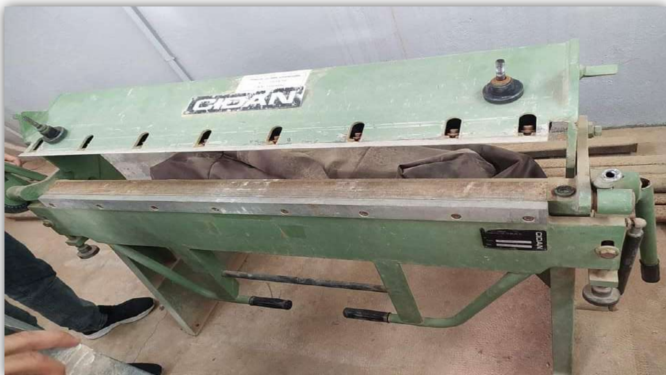
Figure (III.6) : L'appareil de cintrage
