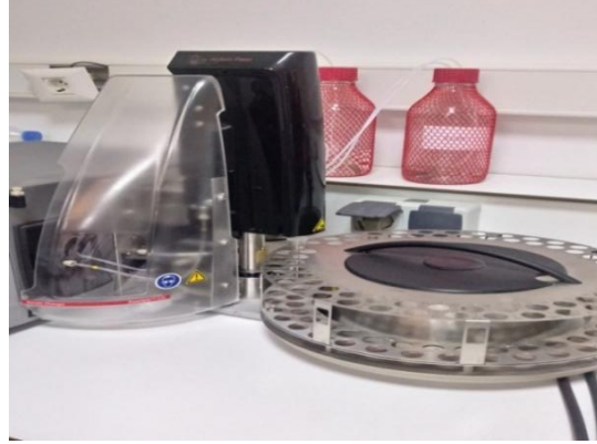
الشكل II.1 جهاز قياس الكثافة واللزوجة.
