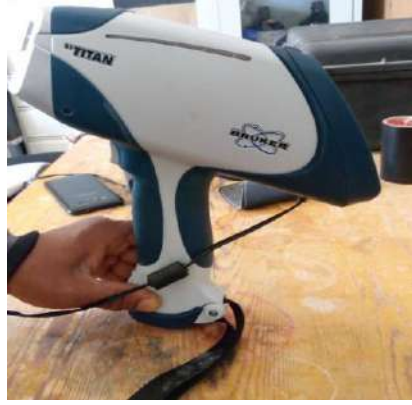
الشكل (II-2): صورة فوتوغرافية لجهاز الأشعة السينية بالفلورة XRF نوع TITAN BRUKER
