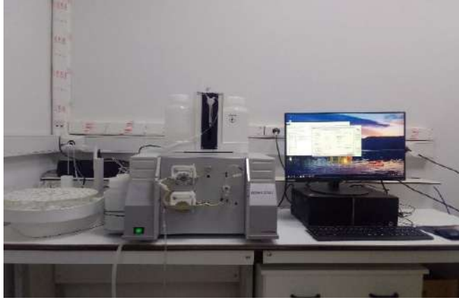
الشكل (II-3): صورة فوتوغرافية لجهاز الامتصاص الذري SAA نوع Analytik Jena.
