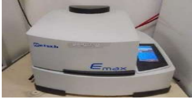
الشكل (3-IV): صورة فوتوغرافية لجهاز الطحن نوع (Retsch Emax).
