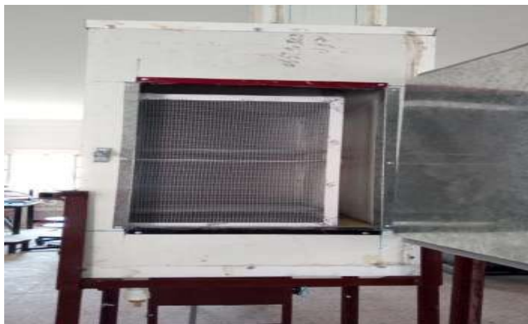
Figure 8 : Réacteur de bio-séchage à isolation thermique.
