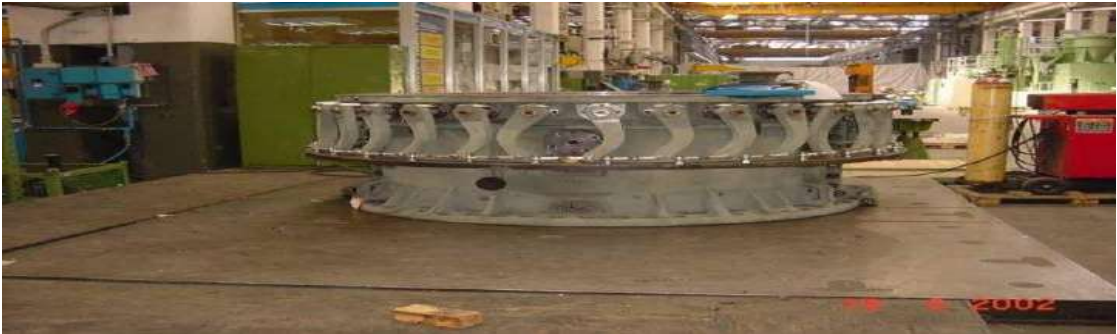
Figure. II.5 : schéma de directrice de deuxième étage [2]
