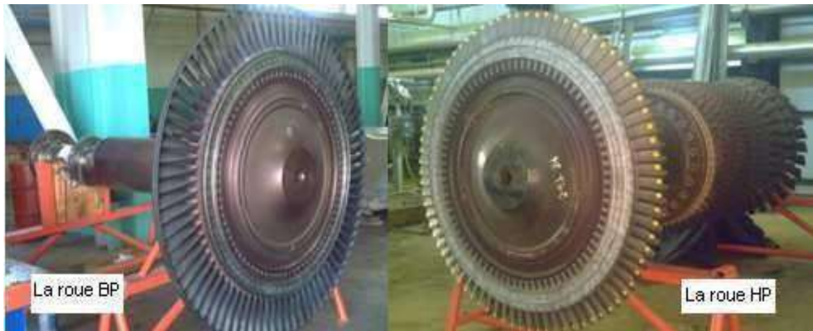
Figure. II.6 : Schéma de rotor HP et rotor BP [28]
