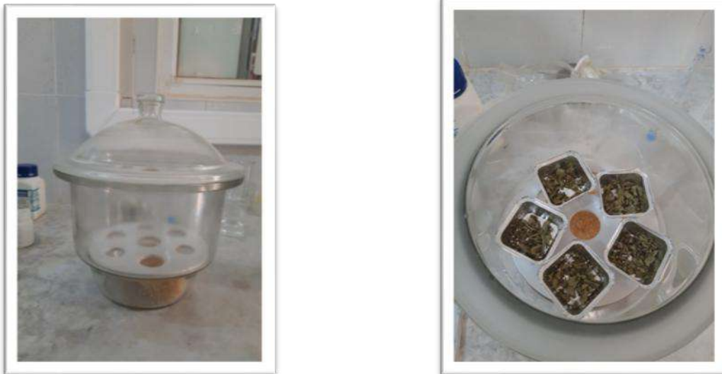
Figure III 10 : Photographies de dessiccateur utilisé pour déterminer la teneur en eau initiale.
