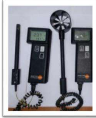
Figure III 4: Anémomètre testo 440 + thermo-hygromètre testo 610.
