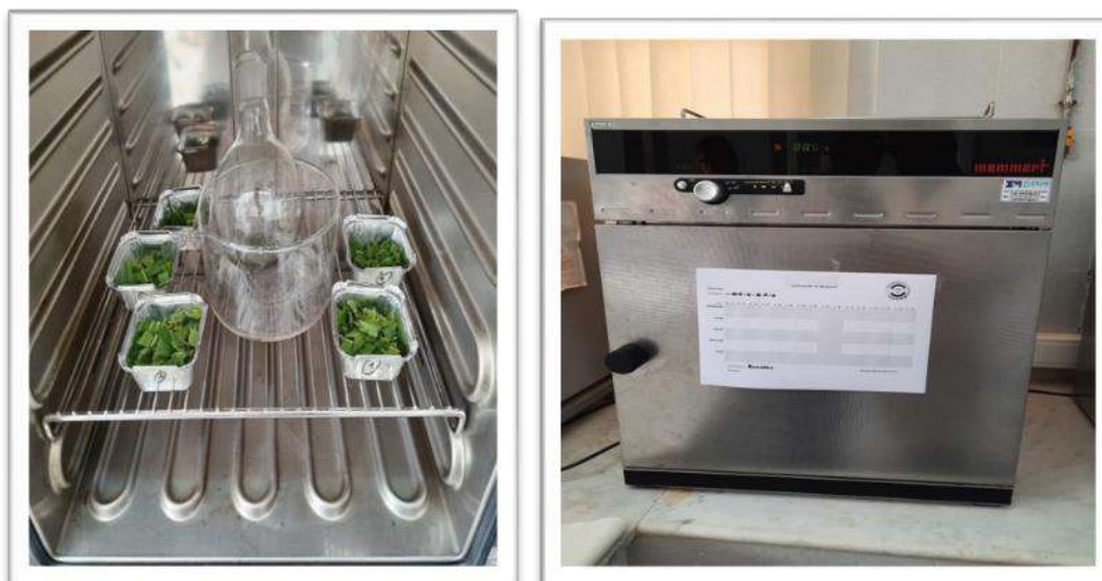
Figure III 11 : Photographies Etuve MEMMERT UNB 100 utilisé pour déterminer la teneur en matière sèche.
