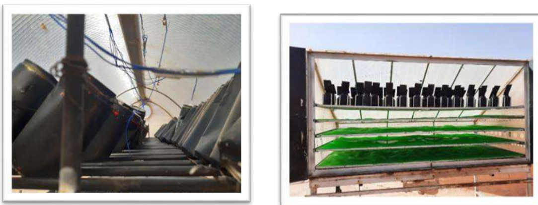
Figure IV.4 Prototypes de séchoirs solaires de type direct tunnel (gauche) et trapézoïdal (droite) avec MCP
