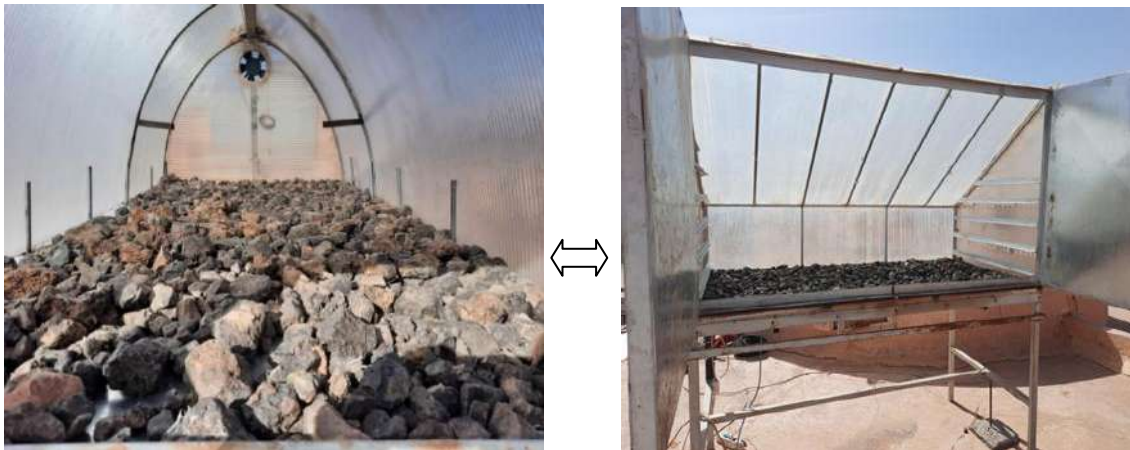
Figure IV.2 Séchoirs solaires de la serre trapézoïdale et la serre tunnel avec stockage thermique sensible (Lit de roches)
