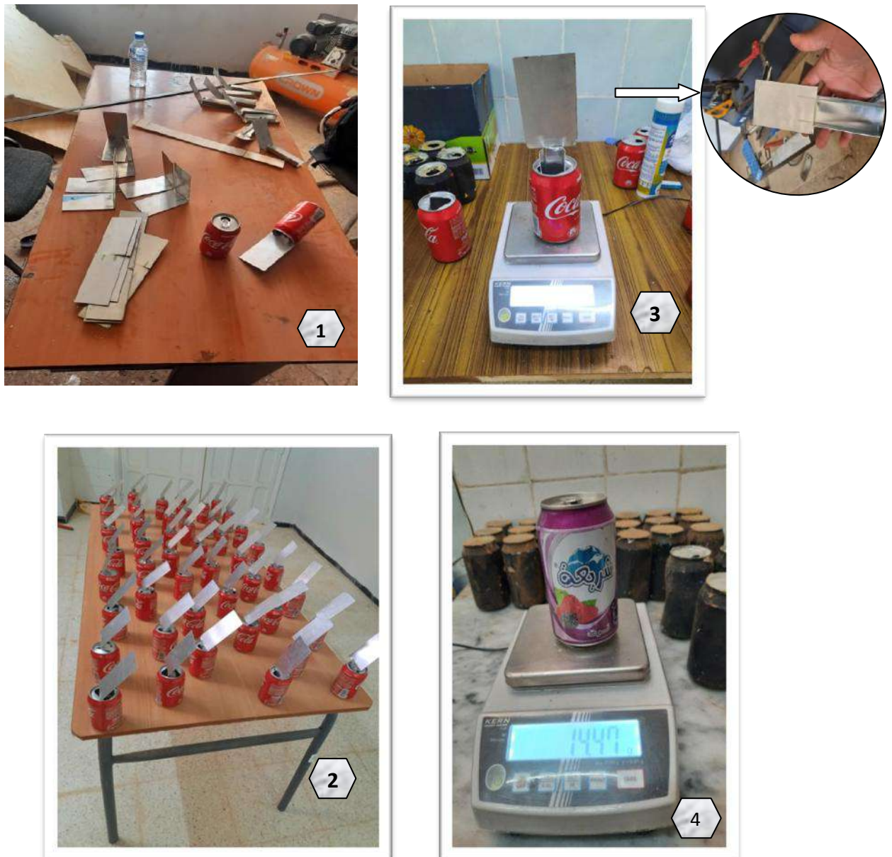
Figure III .18 : Préparation des ailettes en aluminium et son intégration dans les canettes.
