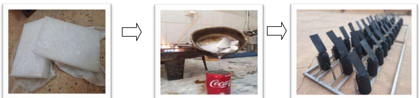
Figure III .19 : Matériau de stockage de l'énergie thermique (paraffine wax) et sont remplissage dans les canettes
