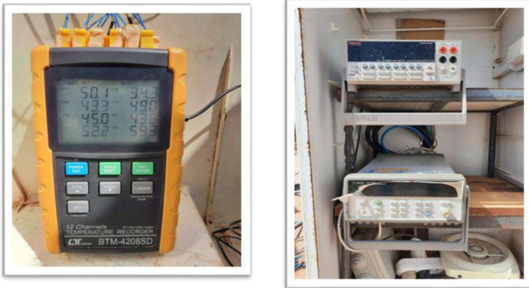
Figure III 7 : Photographie de la centrale de mesure 12 cannales température recorder et keithley 2701.
