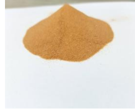
الشكل 3. II: عينات الرمل قبل و بعد السحق اليدوي بواسطة مدقة هاون.
