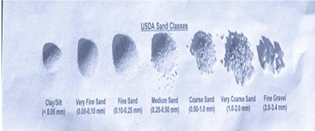
الشكل 5.I: تصنيف حبيبات الرمل وفقا لأبعادها.
