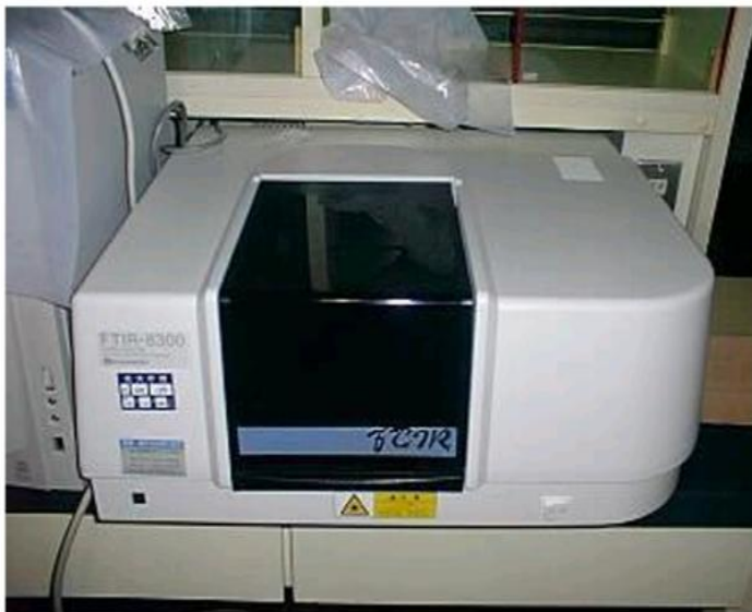
الشكل 14.ii: مطياف FTIR المستعمل في الدراسة.
