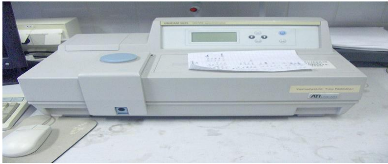
الشكل (II. 8) : يمثل جهاز القياس الضوئي فوق البنفسجي.
