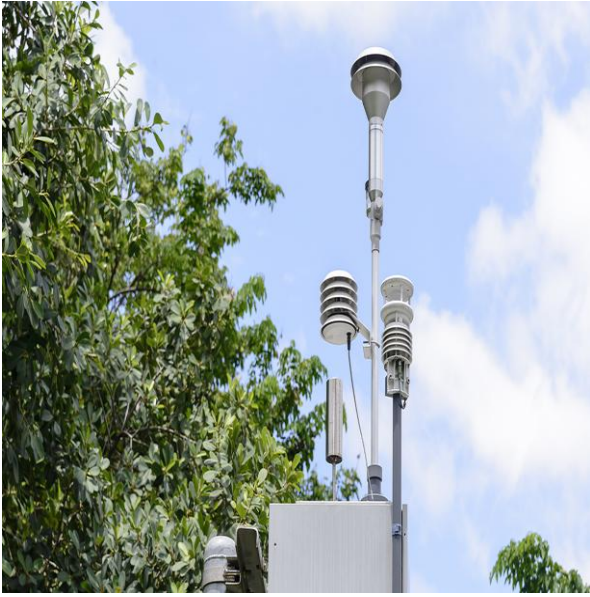
الشكل (3. II): يمثل الأجهزة المستخدمة لرصد و مراقبة تركيز الأوزون.
