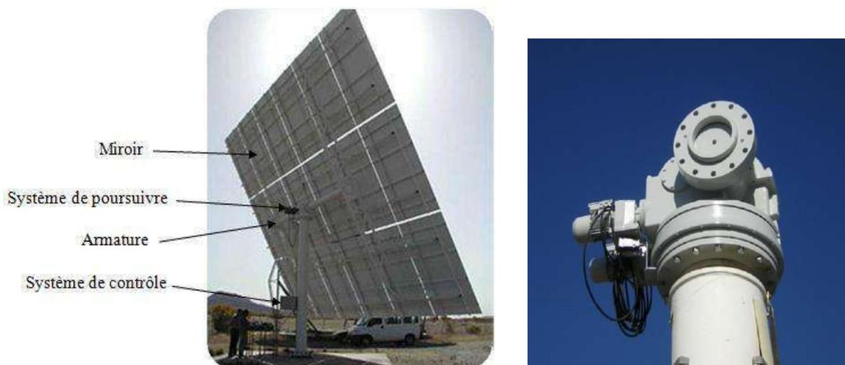
**Figure II.4 :** Système de suivi solaire héliostat [31, 32].
