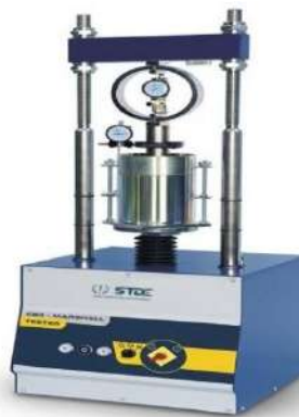
Figure (III.5) Schéma d'une presse CBR
