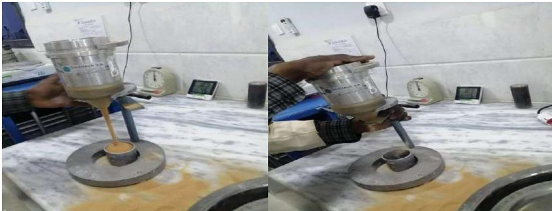
**Photo II.4 : Essai de la masse volumique apparente.**
