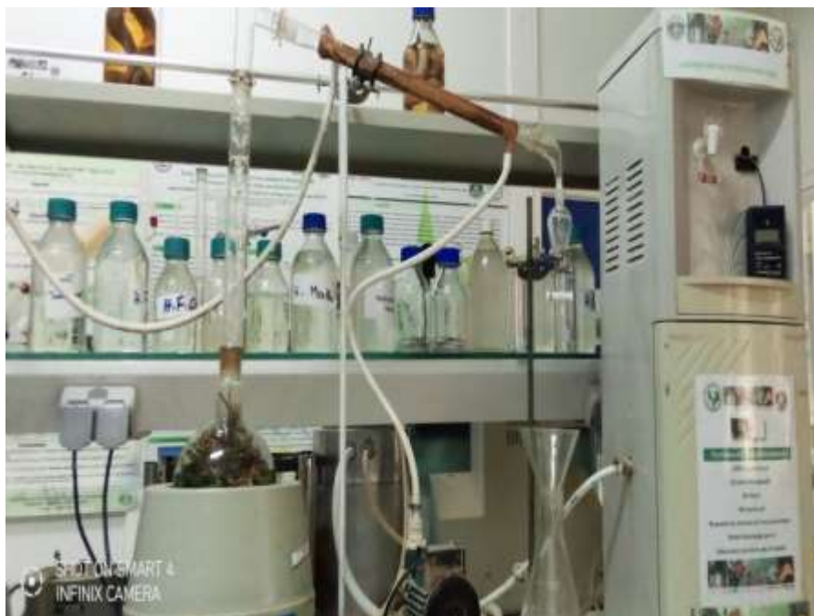
Figure (10) : Montage d'hydrodistillation utilisé lors d'extraction
