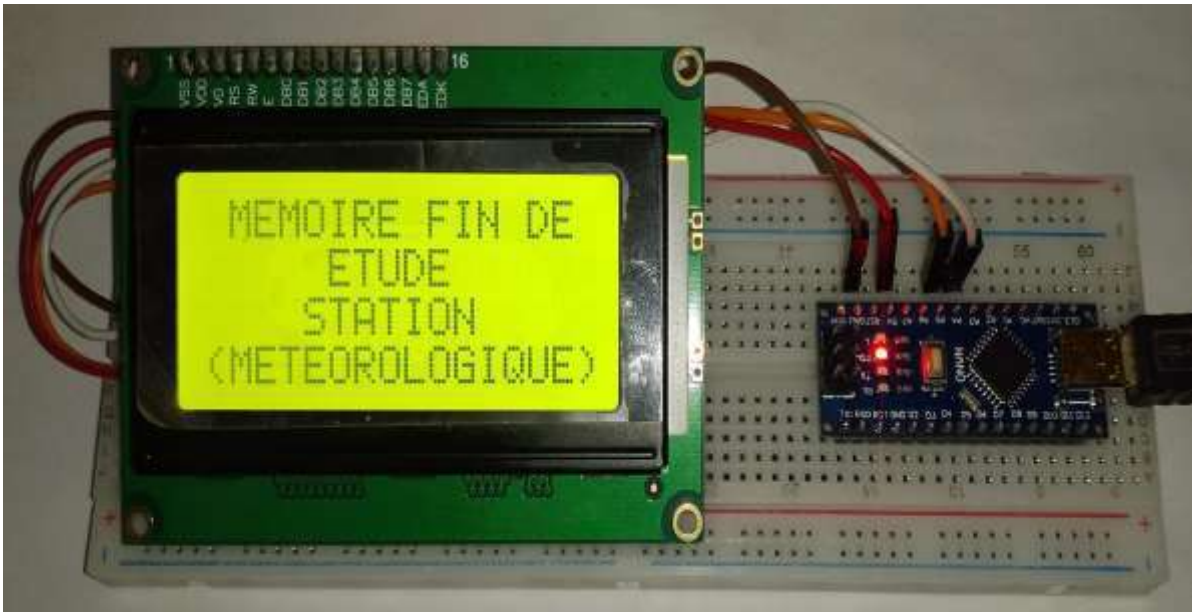
Figure II.4 Montage réel pour montrer le fonctionnement et le brochage du LCD 16 × 4
