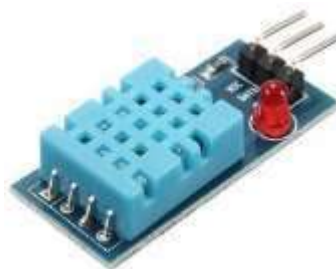
Figure II.9 Boîtier du capteur DHT11
