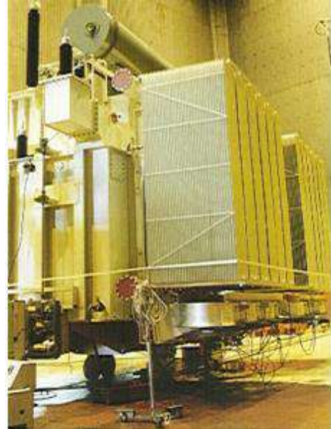
Figure I.14 Radiateurs sur un transformateur [5].
