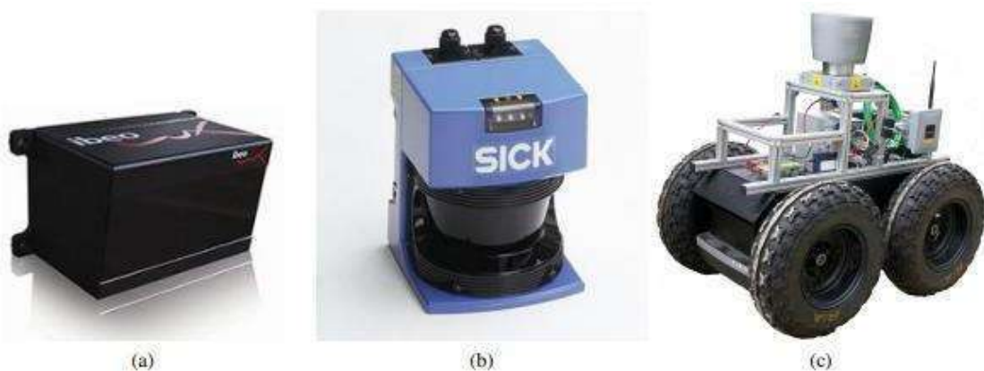
Figure I.8 : (a) Télémètre laser de haute résolution de la compagnie Ibeo (b) Capteur LMS200 de Sick Inc. en Allemagne ; ce capteur est fréquemment utilisé sur les robots pour la navigation à vitesse modérée (c) Capteur Velodyne [11].
