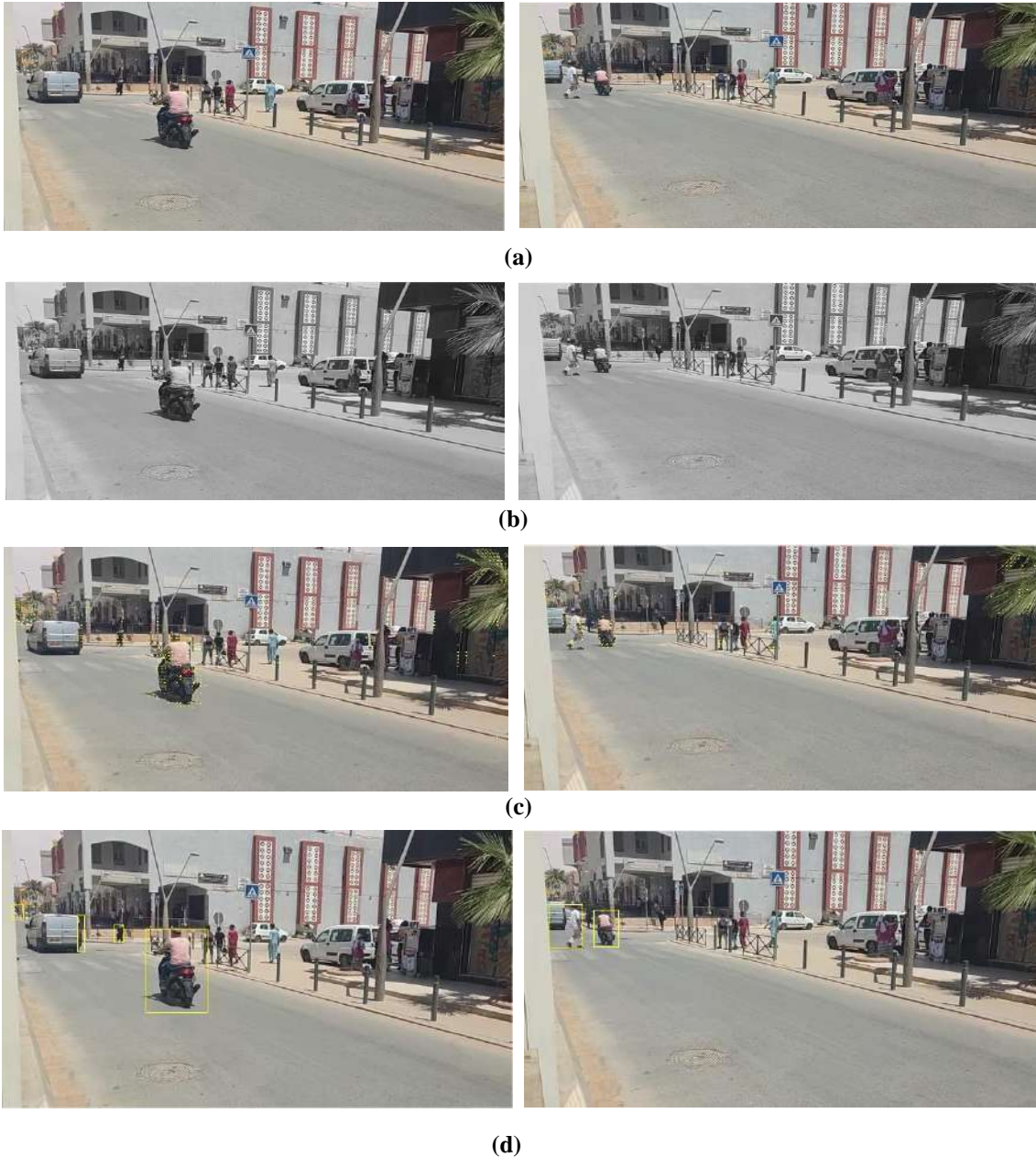
Figure III.22 : Résultats de la méthode de flux optique Horn-Schunk sur une séquence vidéo avec une caméra Mobile dans un environnement extérieur (outdoor). (a)image Originale ; (b) binaire (c) flux optique (d) boîte
