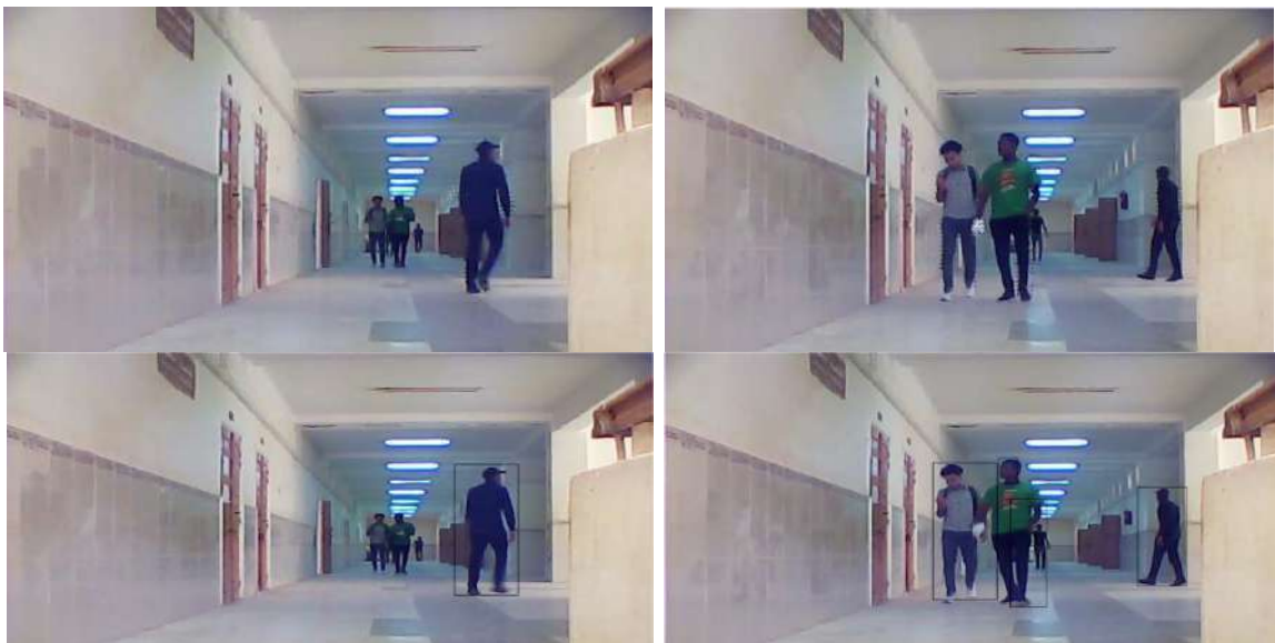
Figure III.19: Résultats de la méthode de flux optique Horn-Schunk sur une séquence vidéo avec une caméra Fixe dans un environnement d'intérieur (indoor).
