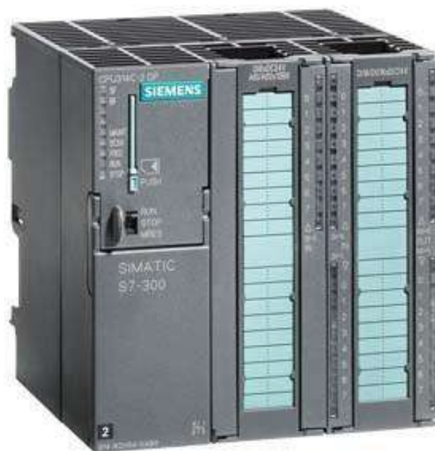
Figure III-6: Automate à deux modules entrées/sorties
