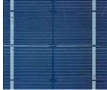
**Figure (I.8) : cellule en silicium poly cristallin**
