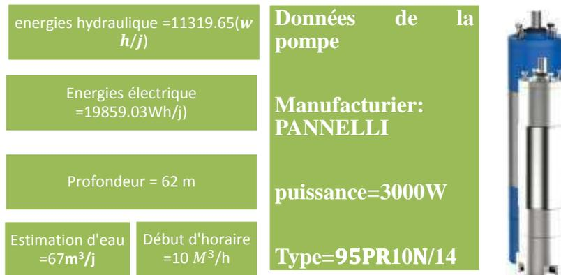
**Figure (III.2): Caractéristiques électriques de la pompe 95PR10N/14**
