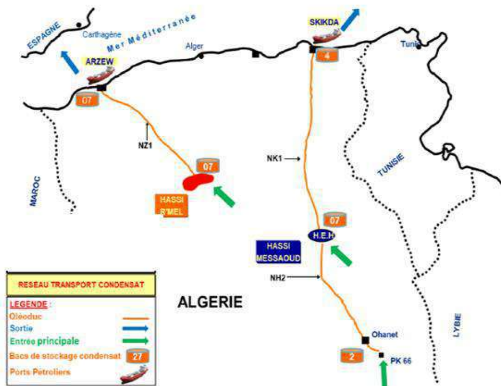
Figure II.5: Carte du réseau de transport du condensat [15].
