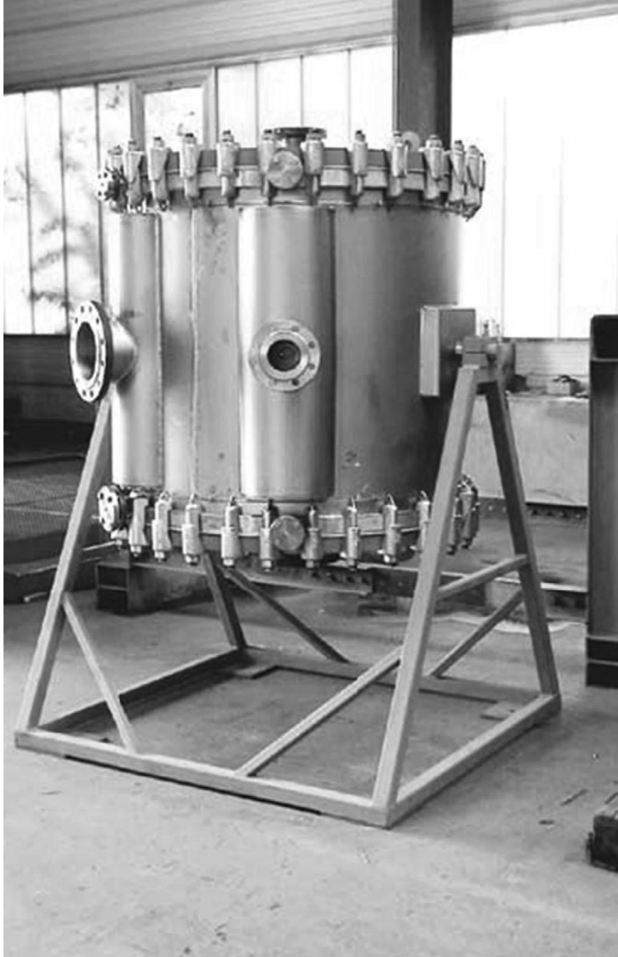
الشكل (1-6): مبادل حراري لولبي (-SPHE Spiral plate heat exchanger)
